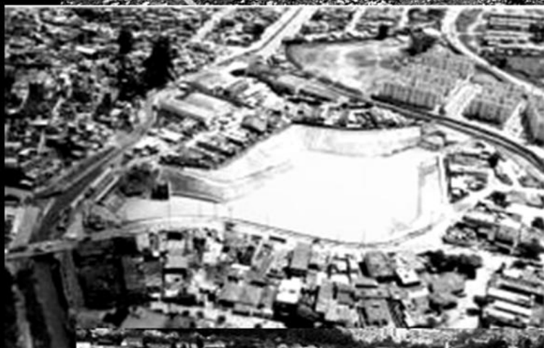
Fotos 10, 11 e 12. "Piscinões", obras de engenharia para minimizar problemas macroestruturais de ocupação desordenada do solo. Cenários de risco que emergem das ações para minimizar outros cenários de risco; no caso, os associados às enchentes.
